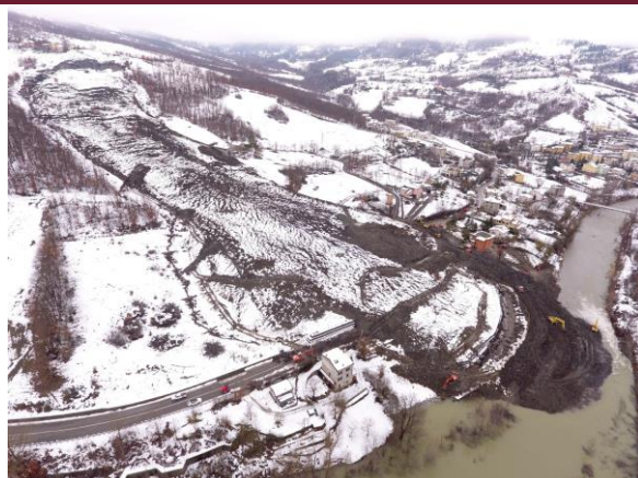
Frana su versante rurale riattivatasi a marzo 2018. Sul versante sono stati individuati segnali di spostamento a gennaio '18
